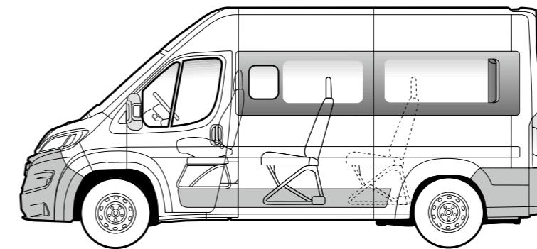
**L2 | L4** | L2-RADSTAND 3.450 mm | L4-RADSTAND 4.035 mm
