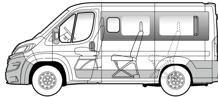
**L1** | RADSTAND 3.000 mm | FAHRZEUGLÄNGE / FAHRZEUGBREITE / FAHRZEUGHÖHE: 4.963 mm / 2.050 mm / 2.254 mm
